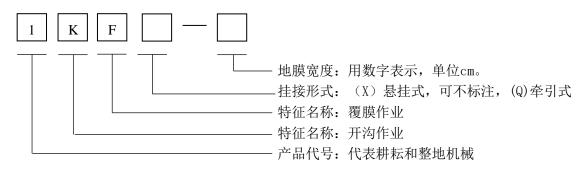
示例:覆膜宽度为 140cm 的牵引式开沟覆膜复式作业机型号标记为: 1KFQ-140
